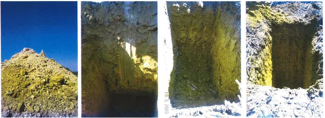
Photographies issues de l'étude du schéma communal d'assainissement – Année 2003 : sols argileux, avec passages de marne grise et de roches gréseuses, friables
